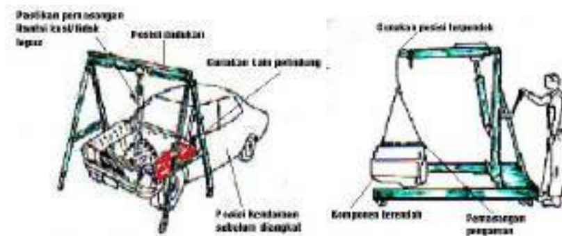
Gambar 2.33 Pengangkatan mesin sewaktu Overhaul (Sumber: dokumen.tips)
